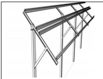
Rysunek nr 3. Akcesoria montażowe do paneli wolnostojących – instalacja jednopodporowa.
