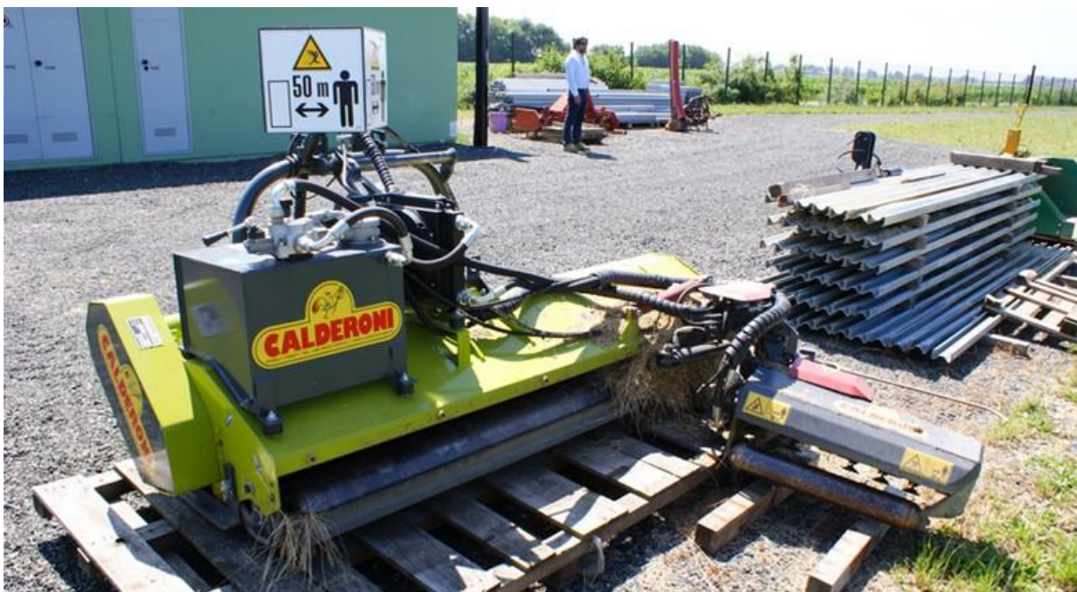
Rysunek 23 Dostawka do ciągnika rolniczego służąca do wykaszania terenu farmy
