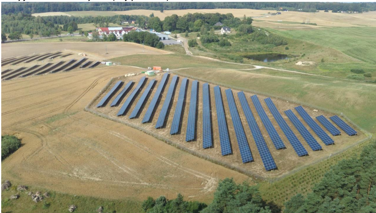
Rysunek 8 Sposób wzajemnego ułożenia paneli fotowoltaicznych
