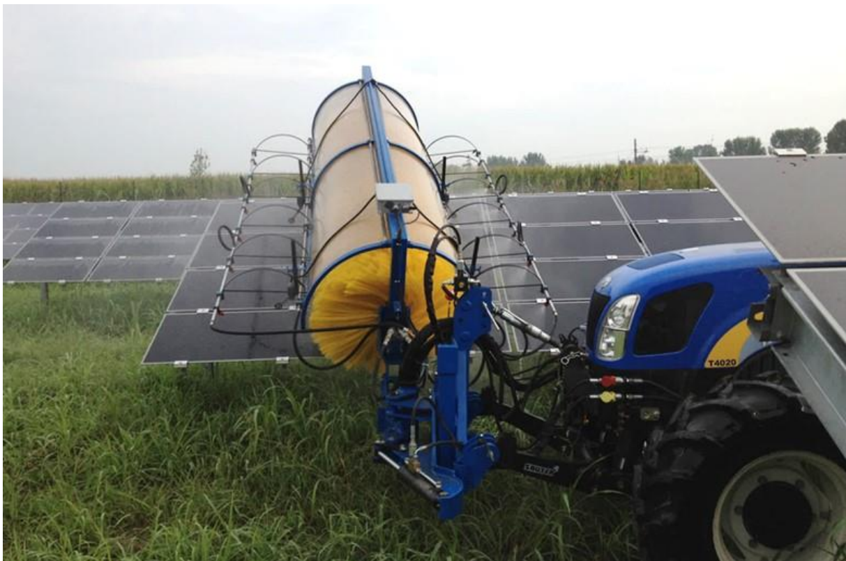
Rysunek 24 Mycie paneli fotowoltaicznych za pomocą specjalnej dostawki do ciągnika rolniczego
