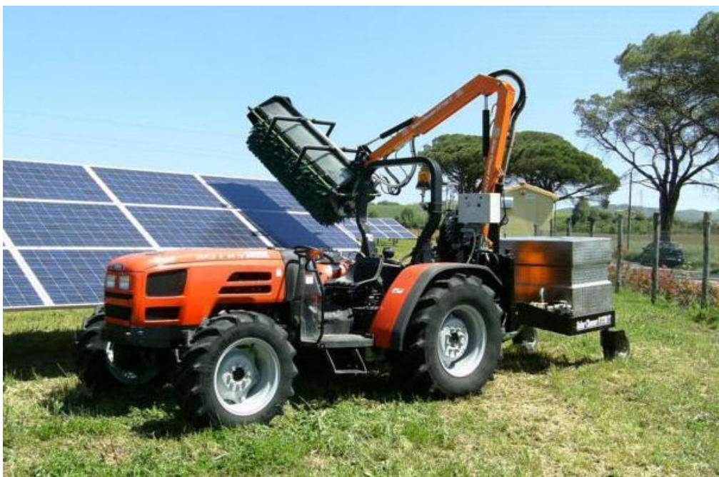
Ryc. nr 12 Maszyna do mycia paneli na farmach fotowoltaicznych Solar Cleaner F1750T
